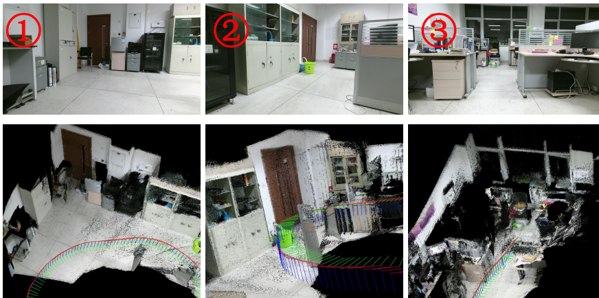
(b) 对应于全景图①②③处的 RGB 图像与局部点云图
