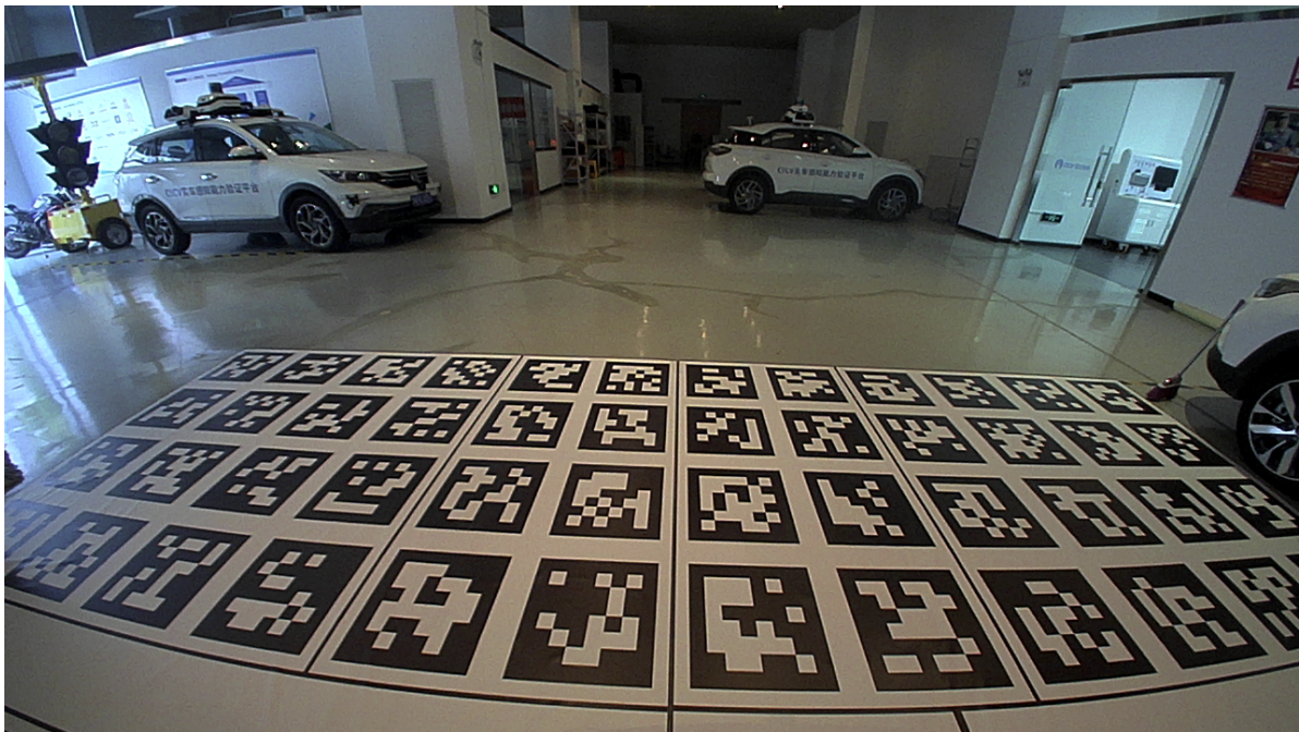
图3.2.4 后视鱼眼相机外参标定图像
